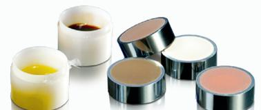
Pote de coleta para carregamento seguro de pós e líquidos prensados
